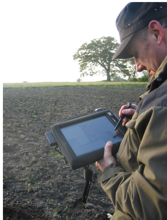
I felt foregår registreringen av jordtyper på en felt-PC med digitale flybilder. Foto: Siri Svendgård-Stokke / NIBIO
