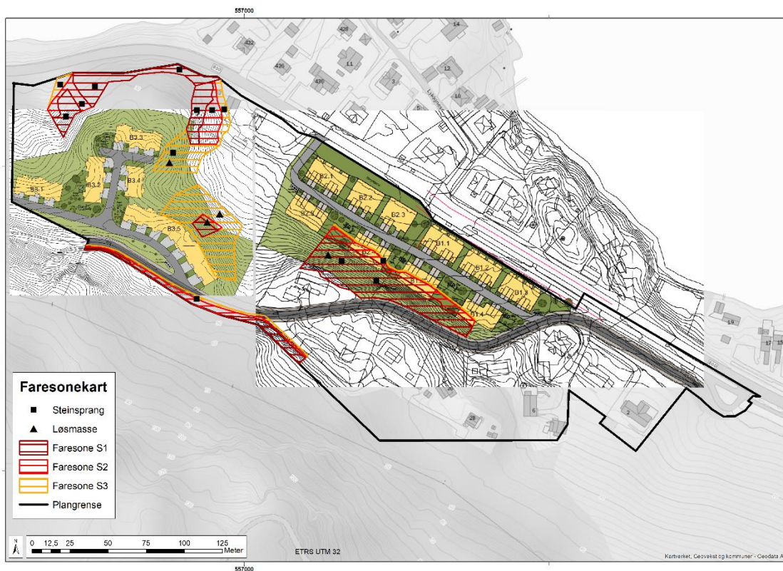
Figur 21: Fastsatte faresoner sammen med gjeldende situasjonsplan. Kravet til fare for skred er ikke ivare tatt innenfor tomtene B2.4, B1.5 og B1.4., samt tilhørende uteareal, hvor det stilles krav etter sikkerhetsklasse S1 og S2. Dersom disse tomtene skal benyttes til planlagt tiltak må det utføres/etableres risikoreduserende tiltak.
